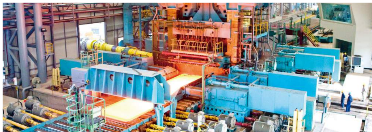
现代化冶金装备行业取得重大进步。图为中国制造的世界最大、精度最高的 5.5 米宽厚板轧机，在造船业、核电业、国防工业等行业起到了重要的支撑作用。
